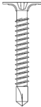
Figure 9 - Vis Aquapanel TTPF
